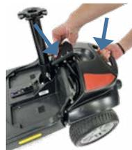
4. Installez le bloc des roues arrière en levant la poignée noire et en clipsant le bloc en même temps
