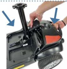
2. Retirez le bloc des roues arrière en levant la poignée noire et tirant sur le bloc en même temps. Soulevez la batterie et séparez-la du scooter
