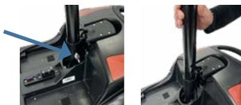
2. Installez le tube de fixation de l'assise
